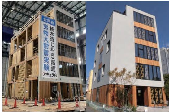
実大振動台実験試験体
