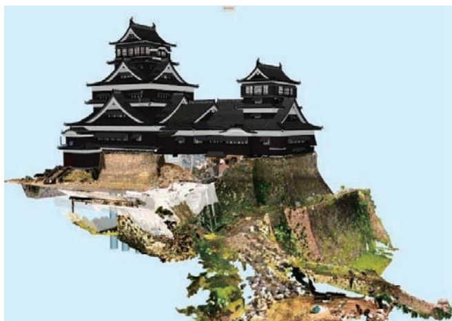
図 14 BIM モデルと点群を結合
