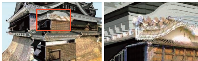
図 15 点群と建築 BIM モデルのずれ
