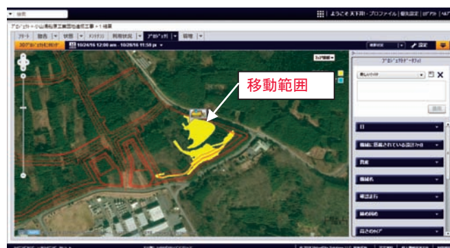
図13 ブルドーザの移動範囲（進捗状況）
