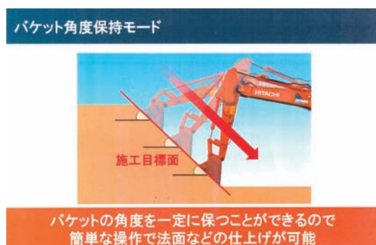
図12 マシンコントロール機能概念図
