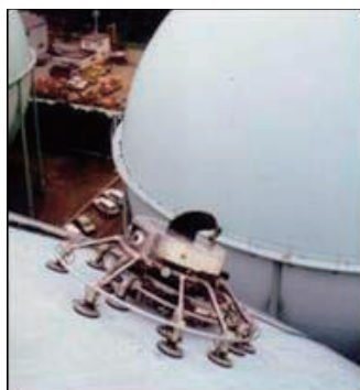
(d) ガスタンクの調査ロボット
