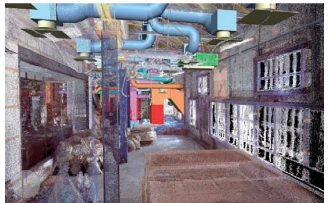
図6 点群データと設備モデルの重ね合わせ
