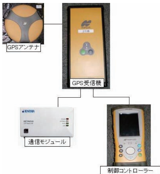
図11 VRS-GNSSの機材構成
