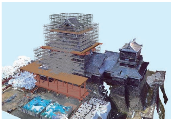
図 18 点群データと仮設 BIM モデル合成
