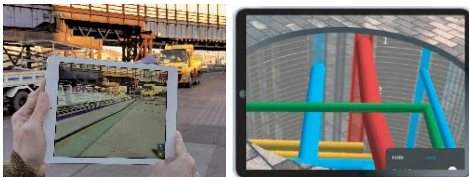
図 5-1 埋設構造物の iPad 表示例（左 2D・右 3D）
