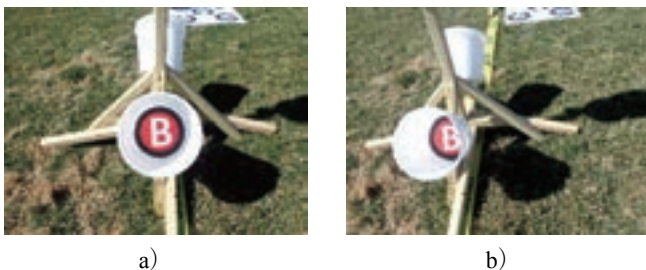
図2 ドローン用STMの基本要素の円筒。a) 円筒を正しい位置から見た状態(底の記号と内接円がすべて見え、円筒の中心軸の延長線上にドローンは位置していることになる)。b) 円筒を不適切な位置から見た状態(底の記号は見えているが内接円は一部が隠れており、円筒の中心軸の延長線上にドローンは位置していない)
