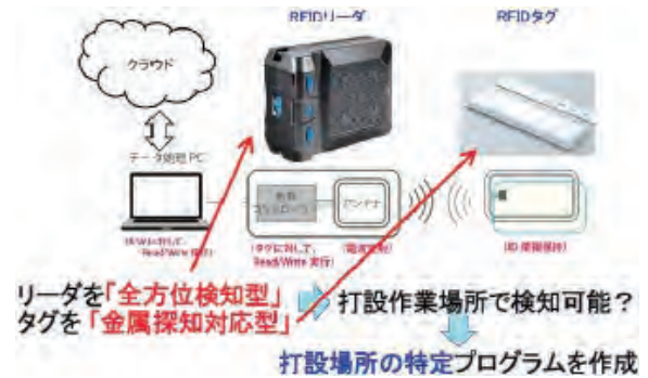
図 20 打設位置自動検知の機材構成
