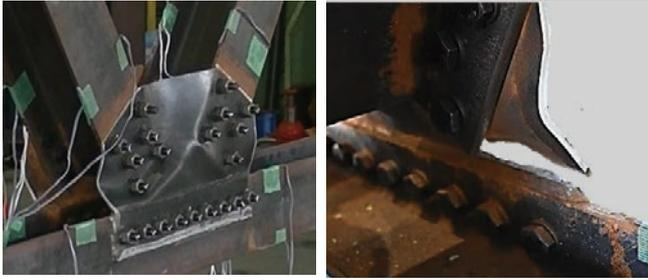
(a) ガセット座屈 (b) ガセットの破断
